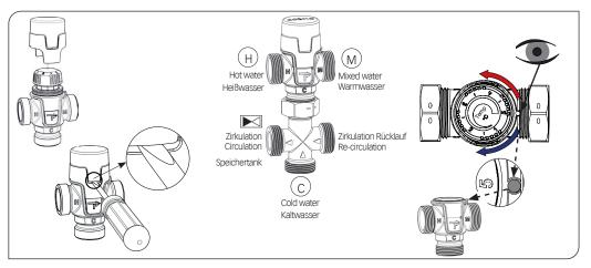
Die Installation muss in Übereinstimmung mit den geltenden Installationsregeln, Gesetzen und Vorschriften durchgeführt werden. Vor Inbetriebnahme der Anlage muss die Wassertemperatur kontrolliert werden um das Risiko von Legionellenwachstum und Verbrennungen zu verhindern. Das Ventil darf niemals unter Druck demontiert werden.
