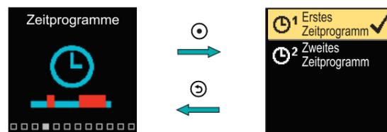
Navigieren Sie mit den Tasten und durch das Menü. Mit der Taste können Sie das Zeitprogramm für den Betrieb auswählen und mit der Taste die Einstellung des ausgewählten Zeitprogramms eingeben.
