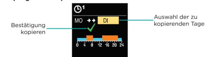
Mit den Tasten und können Sie den Tag auswählen, für den Sie das Zeitprogramm des angezeigten Tages bearbeiten oder kopieren möchten. Bestätigen Sie das Kopieren des Zeitprogramms durch Drücken der Taste . Das Kopieren des Zeitprogramms verlässt man mit dem Drücken der Taste .
