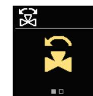
Sie können die Öffnungsrichtung des Mischventils auswählen. Verwenden Sie die Tasten ⏪ und ⏩, um zwischen den Richtungen zu navigieren. Bestätigen Sie die ausgewählte Richtung mit der Taste ⏩. Wenn Sie versehentlich die falsche Richtung ausgewählt haben, können Sie mit der Taste ⏪ zur Richtungsauswahl zurückkehren.
