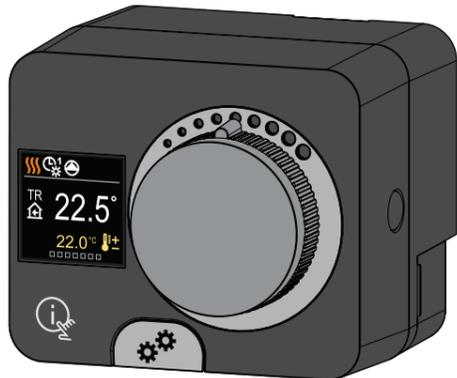
Der CWR7 ist ein kompakter, witterungsgeführter Heizungsregler, der in das Stellmotorenhäuse eingebaut ist. Es ermöglicht die direkte Montage an mehr als 20 Mischventilen verschiedener Hersteller. Der Regler kann auch in Systemen ohne Außenfühler verwendet werden, wobei die Verwendung einer Raumeinheit obligatorisch ist.
