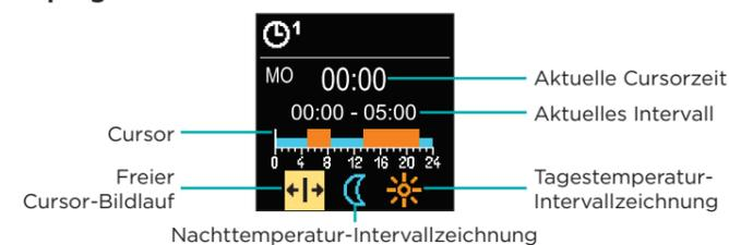
Wählen Sie mit der Taste die gewünschte Ikone aus, um das Intervall zu scrollen oder zu zeichnen. Verwenden Sie dazu die Tasten und , um den gewünschten Verlauf des Zeitintervalls zu zeichnen. Das Einstellen des Zeitprogramms verlässt man mit Drücken der Taste .
