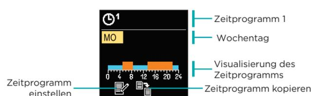
Mit den Tasten und können Sie den Tag auswählen, für den Sie das Zeitprogramm bearbeiten oder kopieren möchten, und ihn mit der Taste bestätigen. Wählen Sie nun mit den Tasten und das Symbol aus, um das Zeitprogramm zu bearbeiten oder zu kopieren, und bestätigen Sie es mit der Taste .
