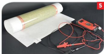
**5** Widerstand gemäß den Widerstandstabellen überprüfen und Werte im Prüfprotokoll und in der Montage-Skizze dokumentieren.
