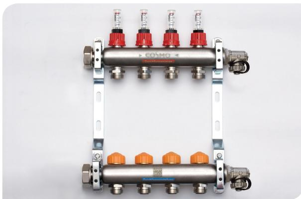
Durch die speziellen AFC-V Ventileinsätze wird im Rücklauf die gewünschte Durchflussmenge je Heizkreis eingestellt. Der eingestellte Wert wird dabei am Durchflussanzeiger – der im Vorlauf eingebaut ist – abgelesen. In der Folge reguliert der **COSMO** AFC-V Edelstahlverteiler seinen Durchfluss dauerhaft selbständig.
